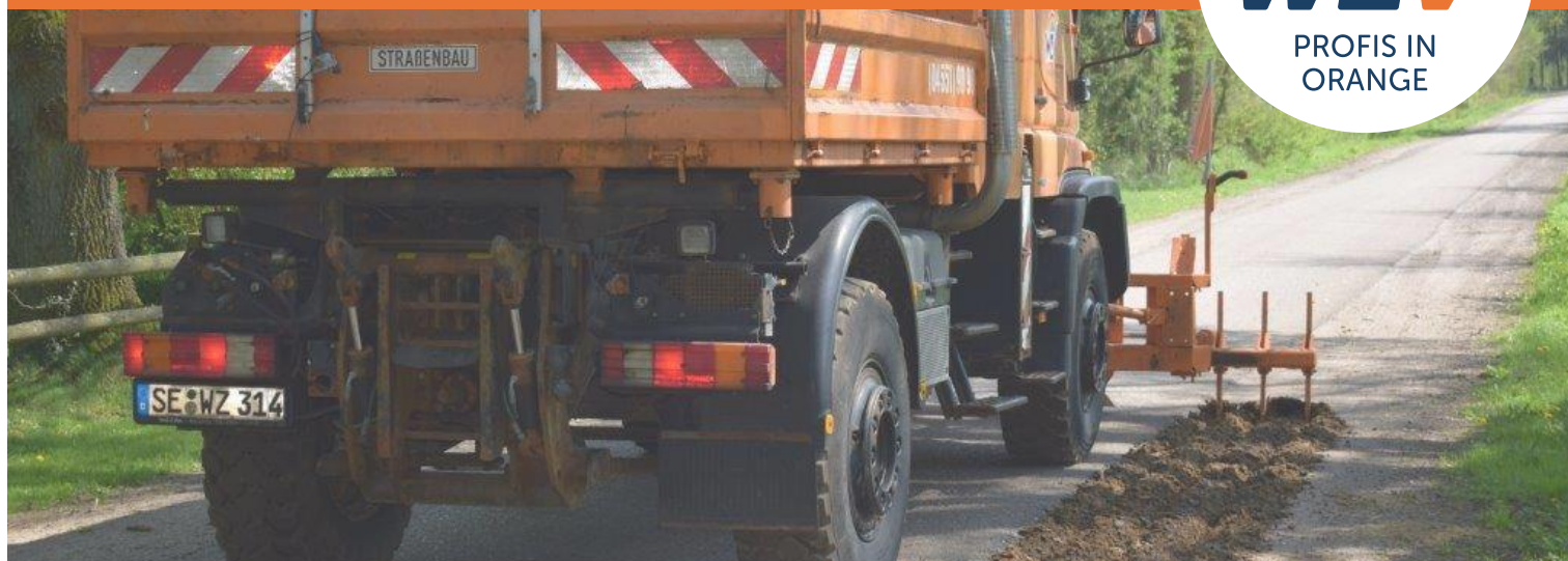
WZV-Konstruktion zum Aufräumen der Bankette
