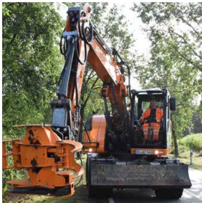
Der Vier-Finger-Greifer mit integrierter Säge
