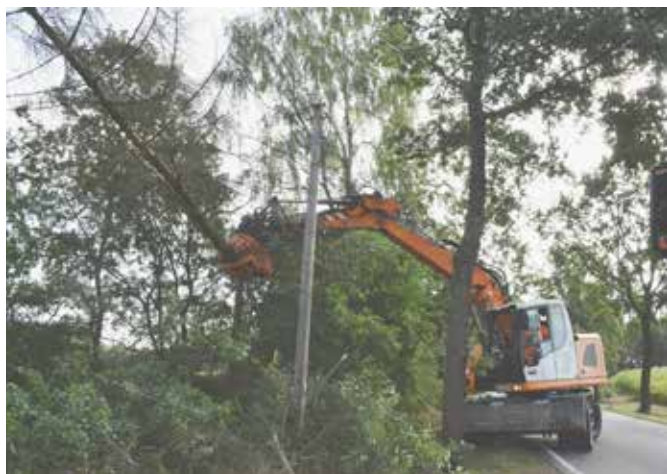
Der abgesägte Baum wird kontrolliert am Straßenrand abgelegt
