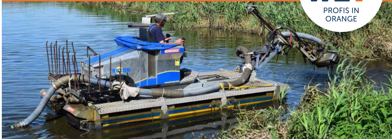
Absaugen des Klärschlammes mittels Amphibienboot
